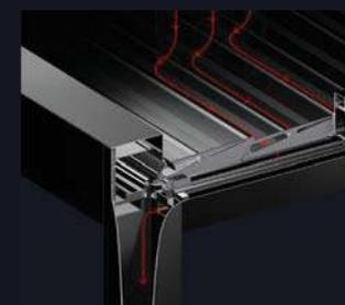
Le lame in alluminio sono progettate specificatamente per condurre il passaggio dell'acqua attraverso le gronde integrate posizionate su tutti i lati.
