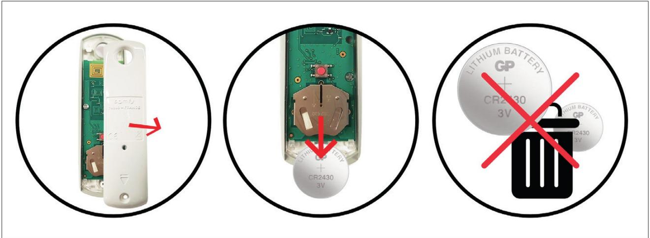
1. Allentare le viti sul retro del telecomando utilizzando un cacciavite e rimuovere il coperchio posteriore.
