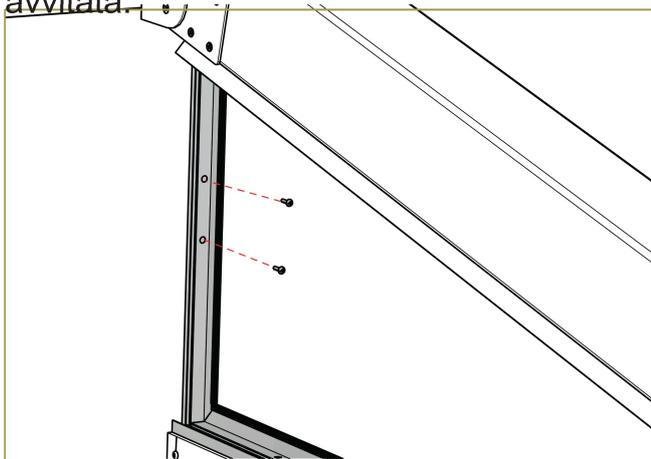
La parte superiore del profilo del telaio deve essere montato sulla struttura.
