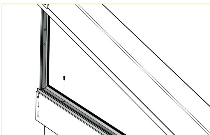
Dopo avere controllato l'allineamento, anche la superficie verticale del telaio va avvitata.
