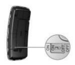
OPEN THE COVER BEHIND THE NINA CONTROLLER AND TURN THE OFF KEY TO ON POSITION. THE CONTROLLER IS READY TO INSTALL.
